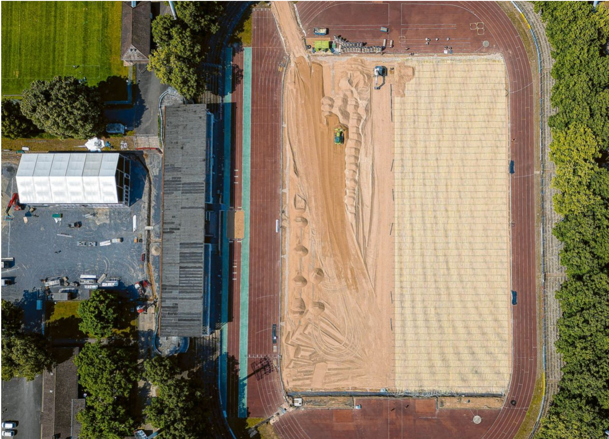
Luftbild des Sachs-Stadions in Schweinfurt. Auf dem Spielfeld in der Bildmitte sieht man rechts die bereits eingebauten Rohre der Rasenheizung. Bis 21. Juni ist geplant, dass die Arbeiten abgeschlossen sind. Vor den Konzerten am 5. und 11. Juli im Stadion wird das Spielfeld abgedeckt, danach wird der Rollrasen verlegt. Fotos: Anand Anders
